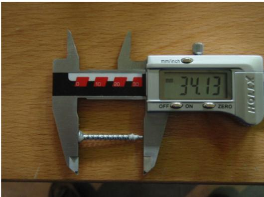
**Bild 29** Schraubenlänge des Schließblechs
