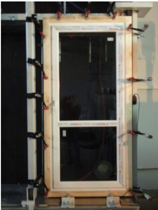
**Bild 1** Probekörperansicht auf Prüfstand Fenster geschlossen
