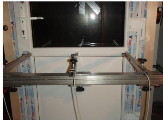
**Bild 4** Prüfaufbau Durchbiegungsmessung
