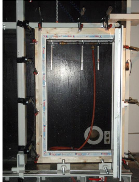
**Bild 2** Probekörperansicht auf Prüfstand Fenster geöffnet
