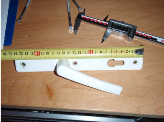
**Bild 33** Länge des Außenschildes
