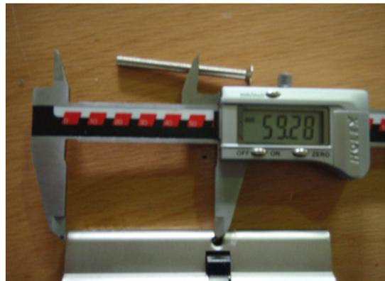
**Bild 32** Länge des Schließzylinders innen
