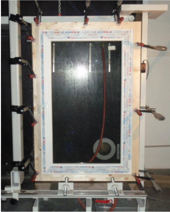
**Bild 1** Probekörperansicht auf Prüfstand Fenster geschlossen
