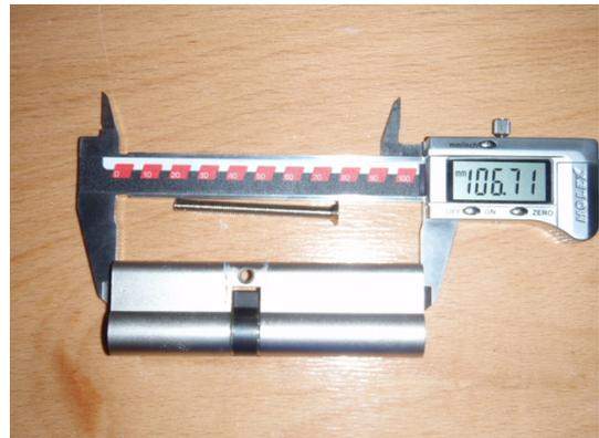
**Bild 30** Länge des Schließzylinders
