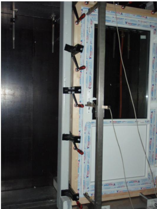
**Bild 3** Prüfaufbau Durchbiegungsmessung
