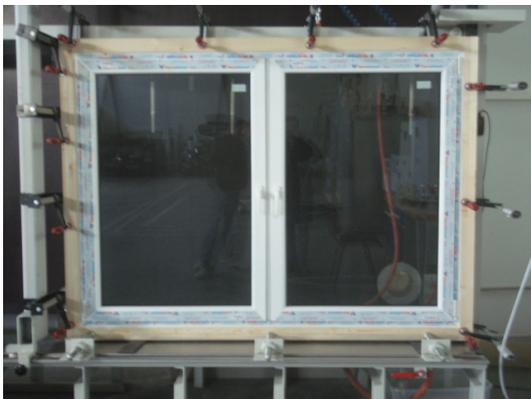
**Bild 1** Probekörperansicht auf Prüfstand Fenster geschlossen
