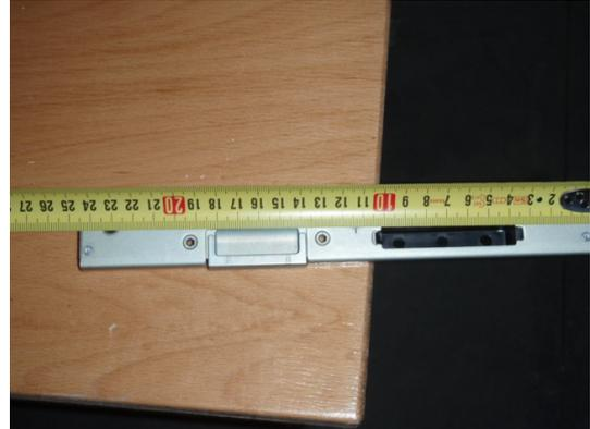
**Bild 28** Länge des Schließbleches
