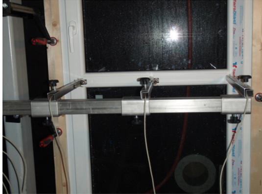
**Bild 3** Prüfaufbau Durchbiegungsmessung
