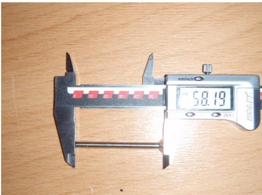
**Bild 31** Schraubenlänge des Schließzylinders
