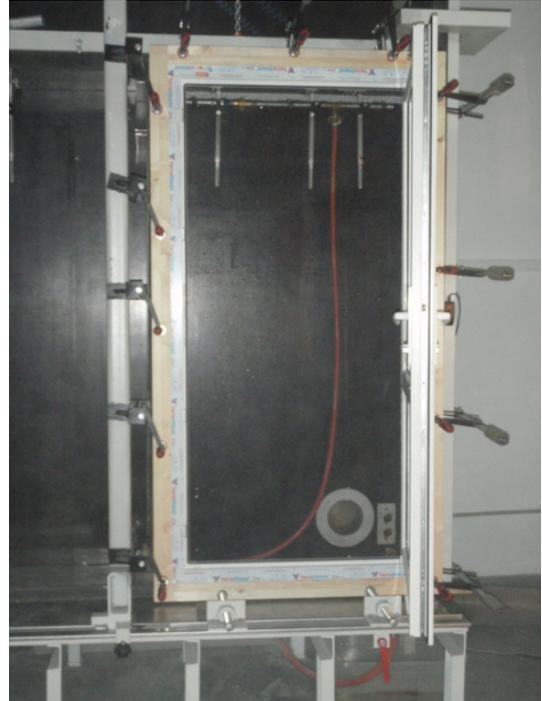
**Bild 2** Probekörperansicht auf Prüfstand Fenster geöffnet
