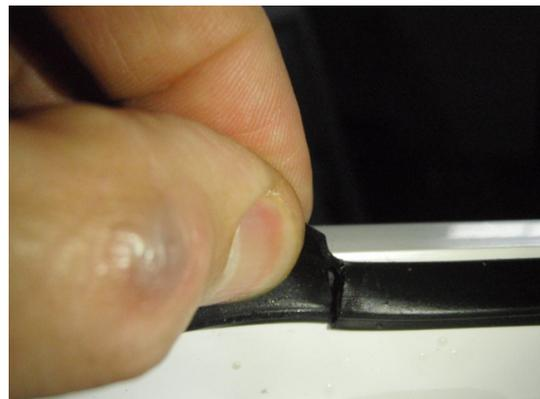
**Bild 7** Innere Anschlagdichtung
