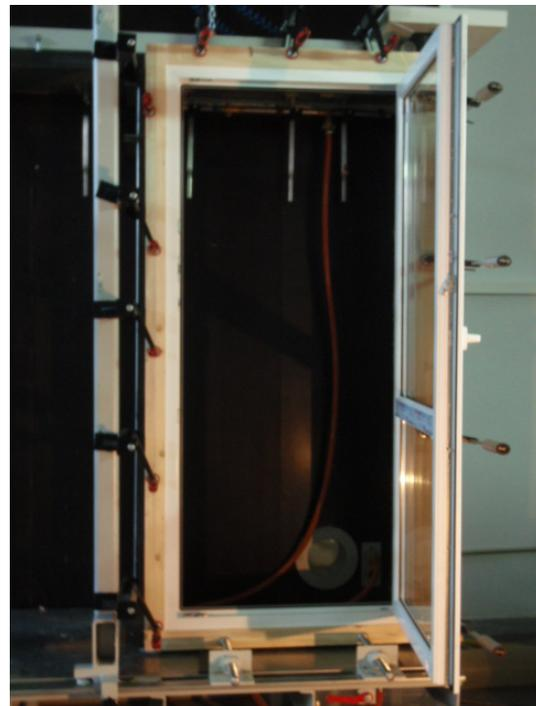
**Bild 2** Probekörperansicht auf Prüfstand Fenster geöffnet
