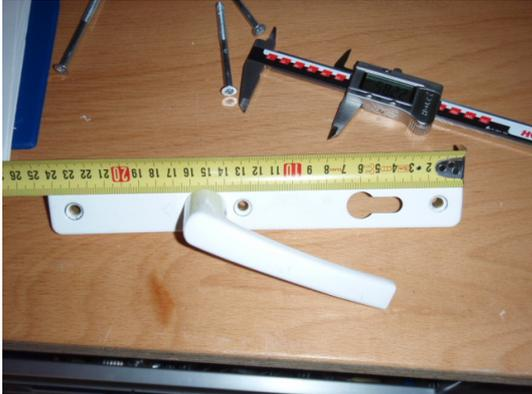
**Bild 24** Länge des Außenschildes
