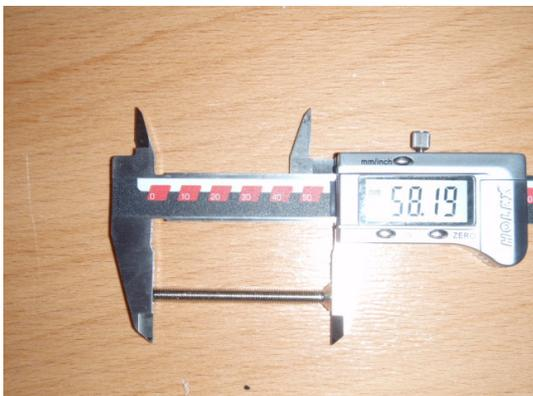
**Bild 22** Schraubenlänge des Schließzylinders
