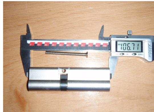
**Bild 21** Länge des Schließzylinders
