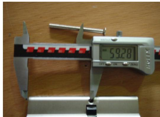
**Bild 23** Länge des Schließzylinders innen
