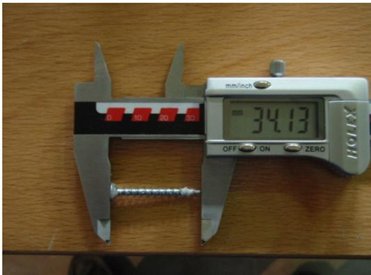
**Bild 20** Schraubenlänge des Schließblechs
